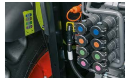
Die Anschlüsse am Heck sind durch ihre Farbcodierung und die in der Nähe angebrachten Aufkleber leicht zu erkennen.
