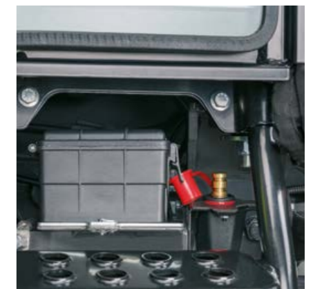
Der AXOS 200 erleichtert Ihnen den Alltag mit vielen intelligenten Lösungen wie z.B. versetzten Batteriepolen auf der rechten Kabinenseite.
